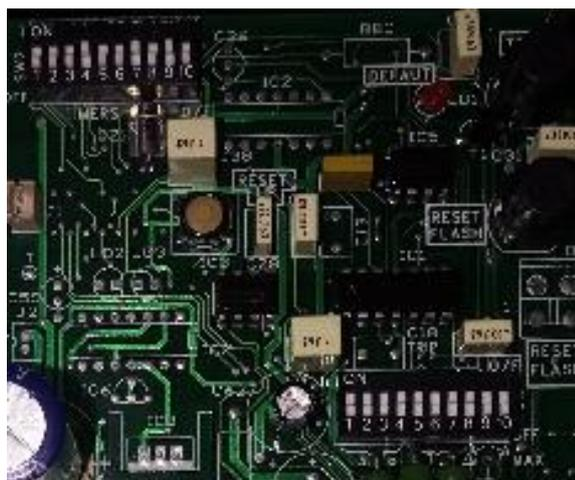
Figure 54: Micro-interrupteurs Flair 219
