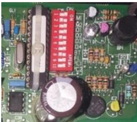
Figure 53: Micro-interrupteurs Flair 279
