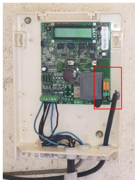
Figure 84: Alimentation auxiliaire DAX
