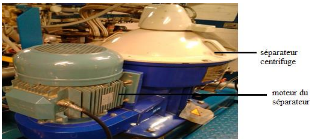
Figure 5: séparateur centrifuge du système de séparation d'huile de lubrification
