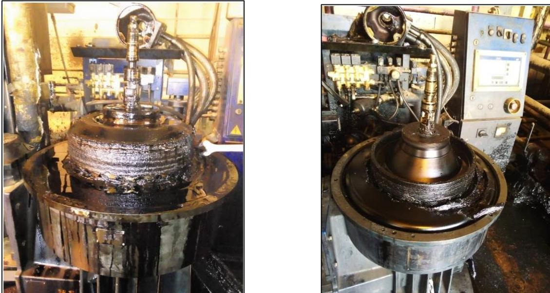
Figure 13 : Mise en évidence des conséquences du mauvais combustible sur un séparateur.
