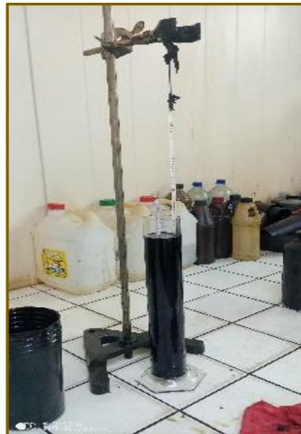
*Figure a : Mesure de la densité du HFO*
