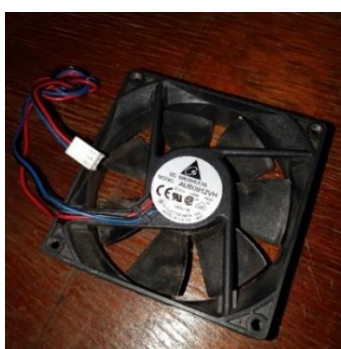
Figure 16: Ventilateur pour le diffuseur d'air
