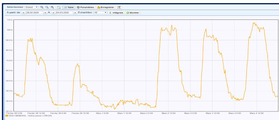
Figure 23 : Mesure de la puissance active au niveau de l'arrivée de l'alimentation générale.
