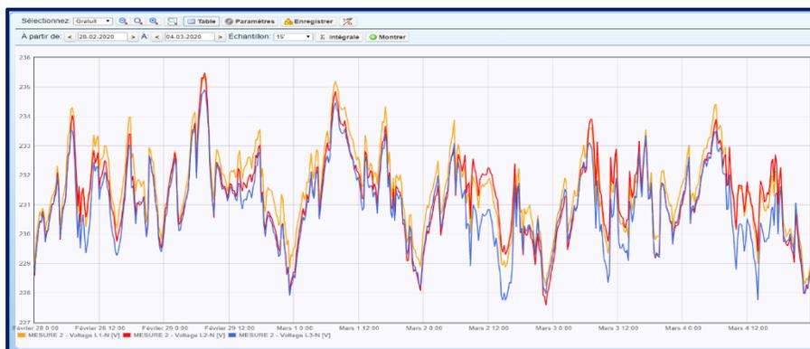
Figure 25 : Mesure de la tension simple au niveau de l'arrivée de l'alimentation générale.
