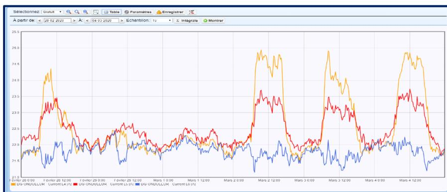
Figure 38 : Mesure de l'intensité au niveau de l'arrivée générale onduleur.
