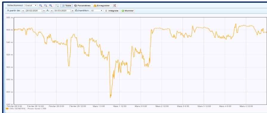
Figure 26 : Mesure du facteur de puissance au niveau de l'arrivée de l'alimentation générale.
