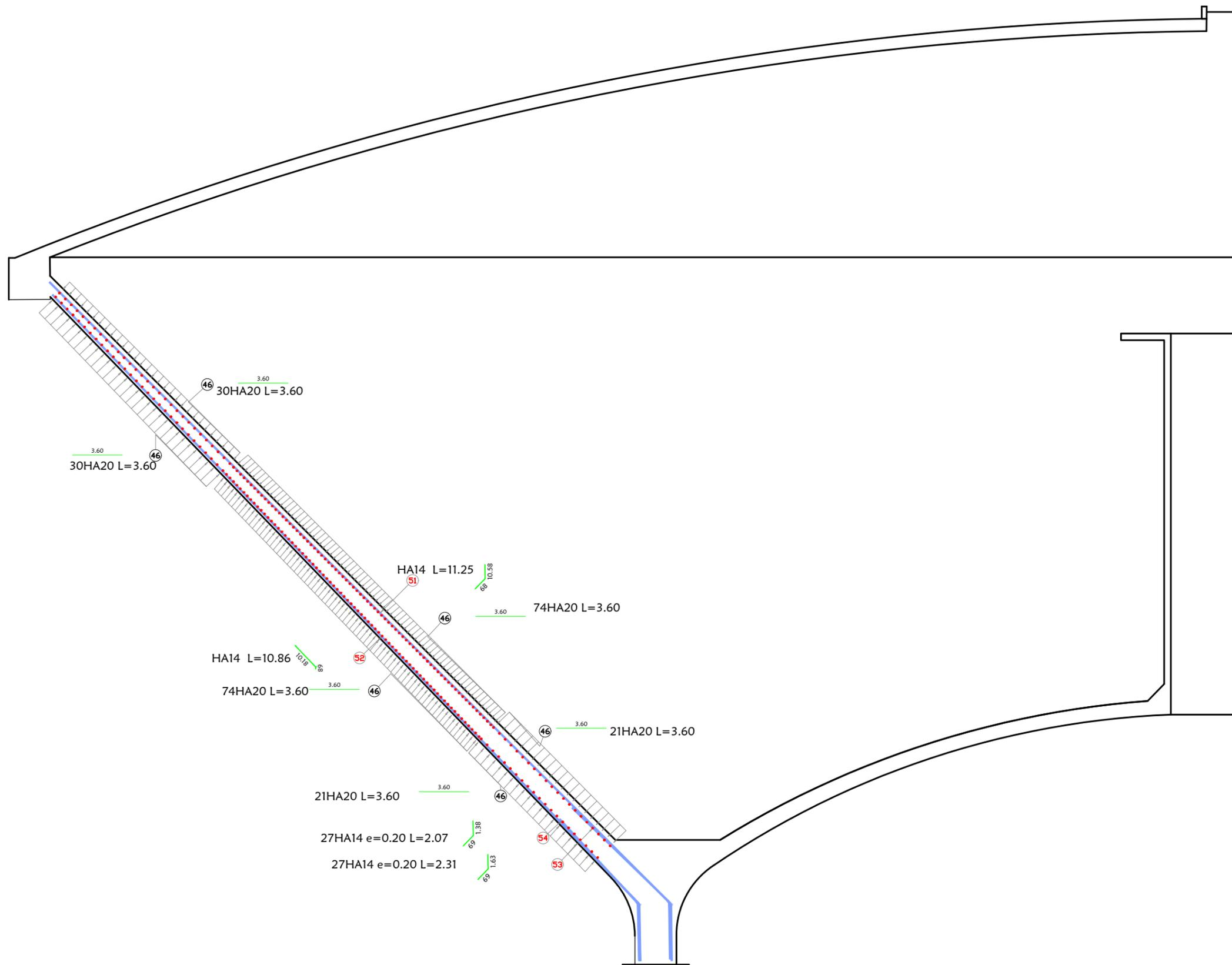
Repartition section des aciers radiaux et des cerces de la cuve tronconique : Ech 1/50
