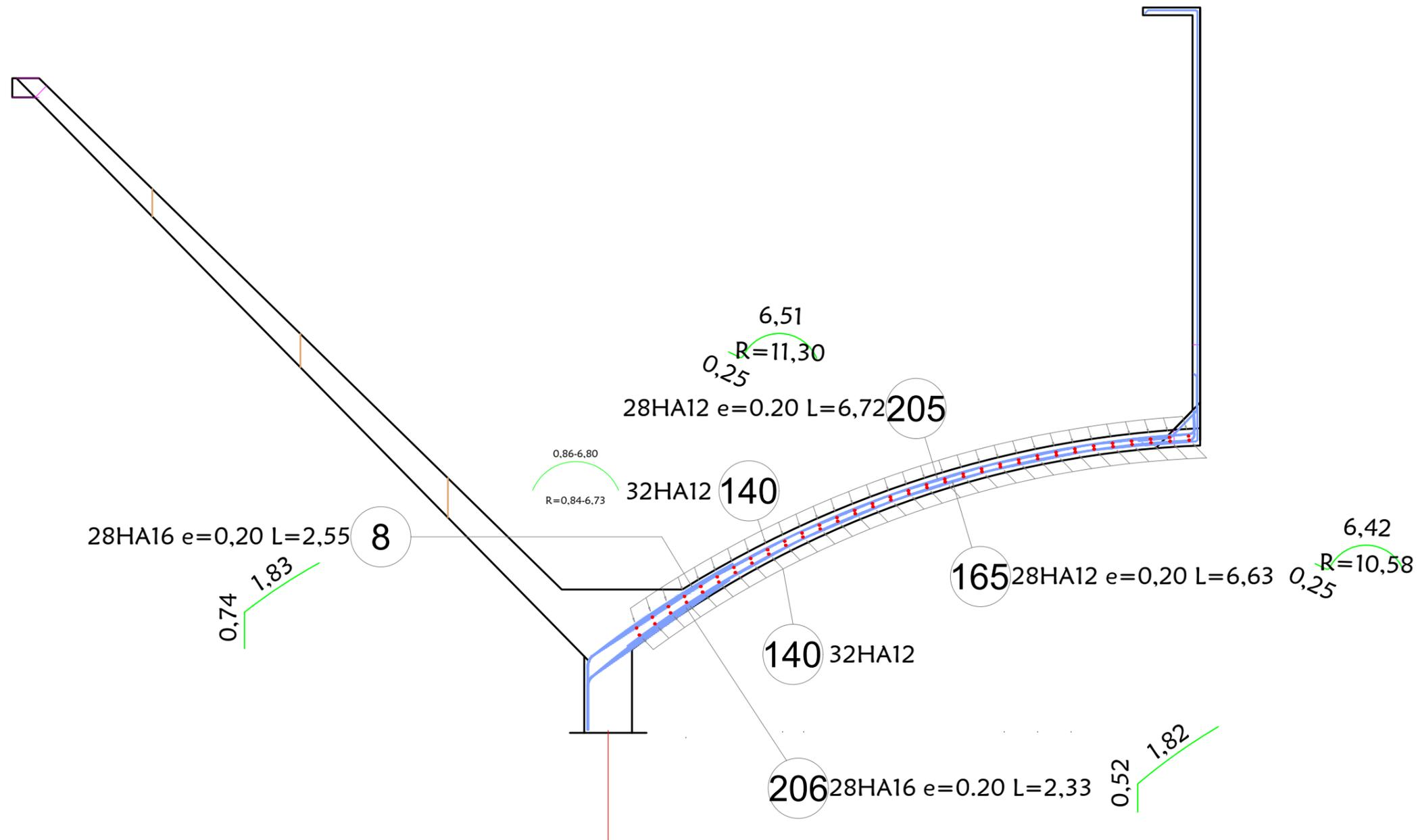
Ferrailage en section des aciers radiaux et des cerces de la coupole inférieure : Ech 1/50
