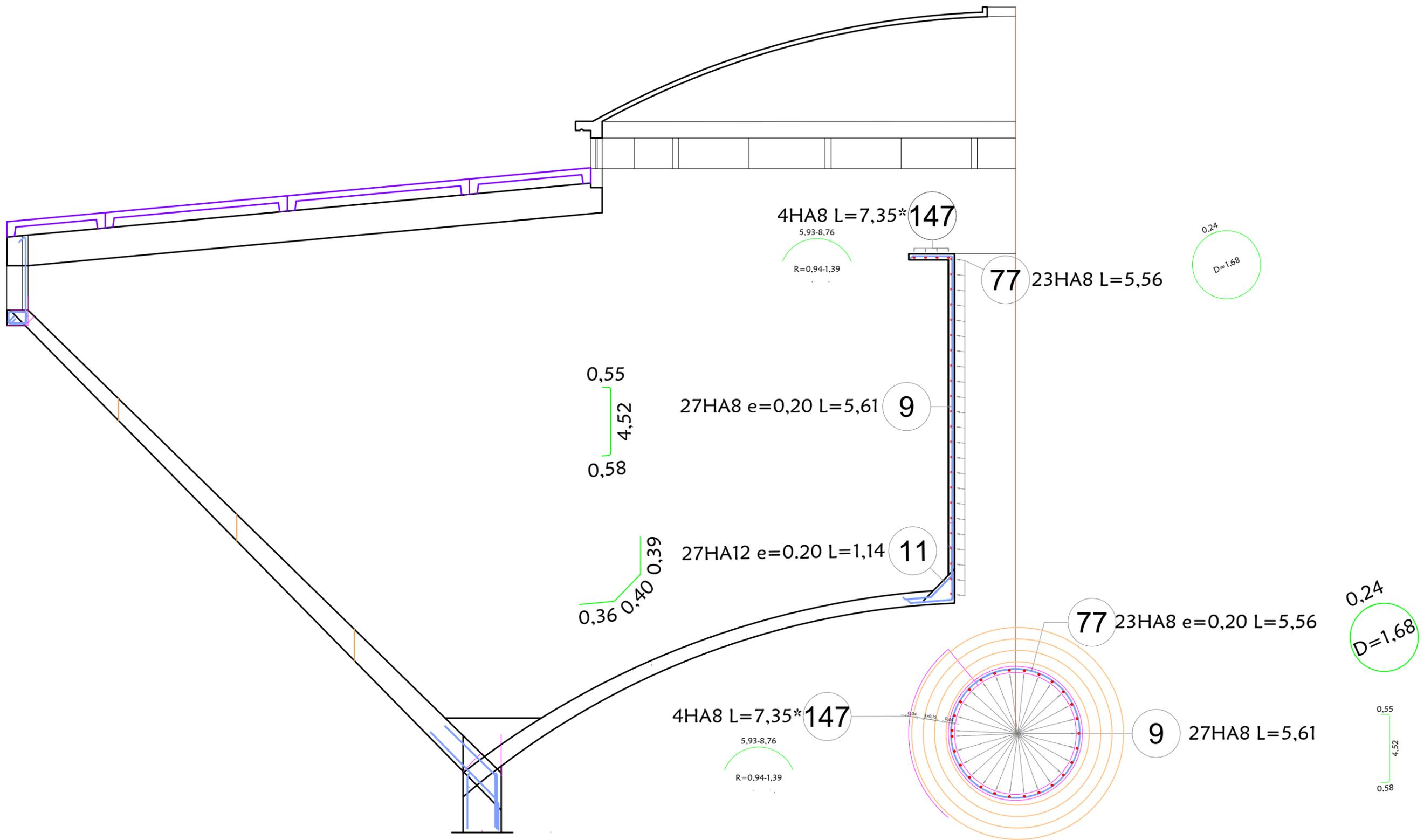
ferrailage en section du cylindre
