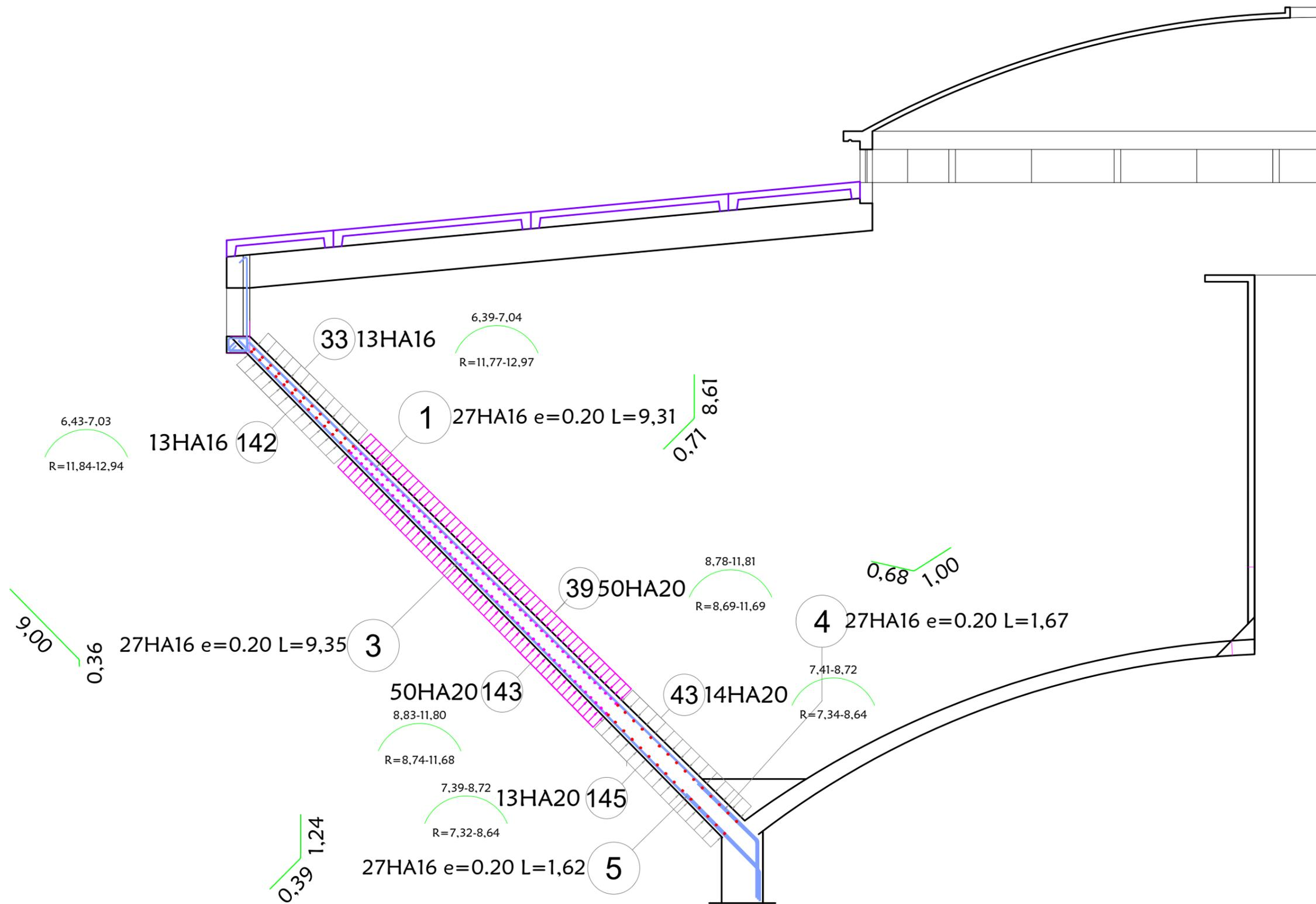
Repartition section des aciers radiaux et des cerces de la cuve tronconique : Ech 1/50
