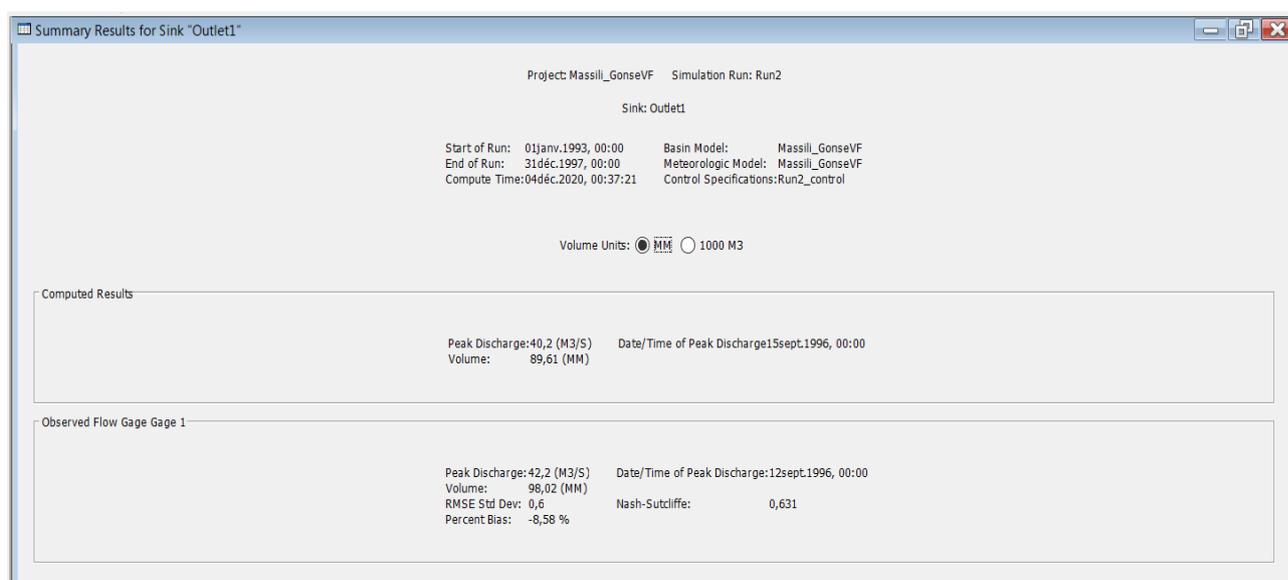
Figure 14 : Résultats de la validation du modèle HEC-HMS
