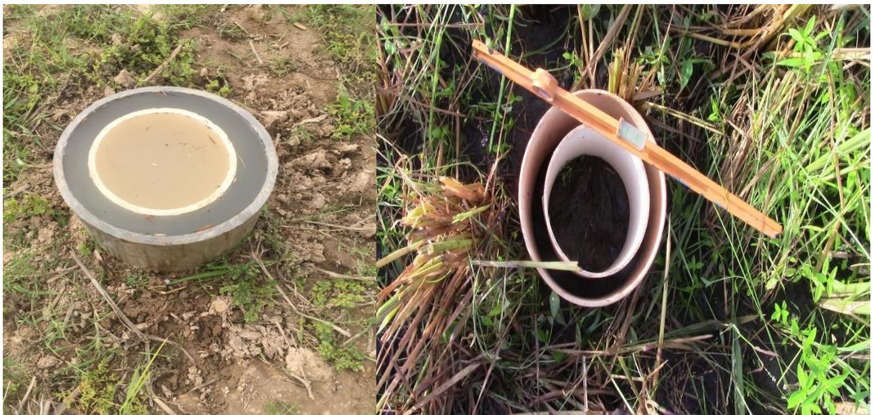
*Photo 1. Mesure d'infiltration avec le double anneau*
