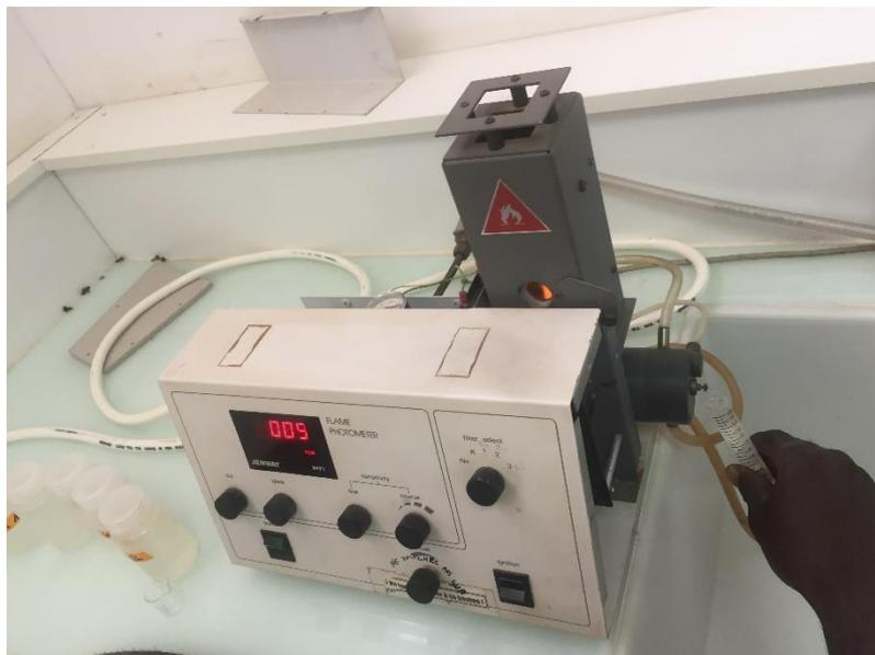
*Figure 22. Spectromètre à flamme*
