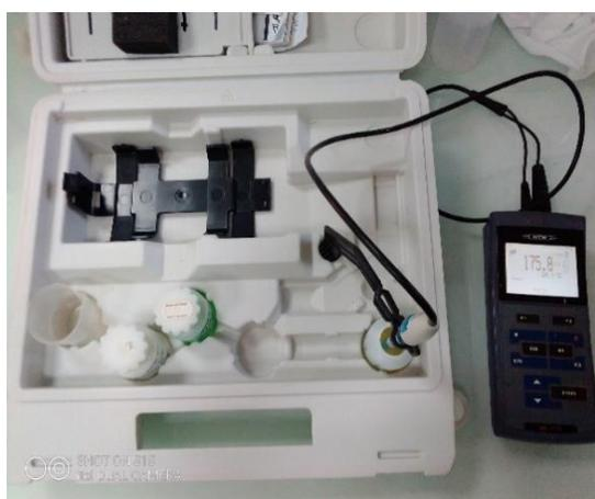
Figure 19. Conductimètre WTW 3110
