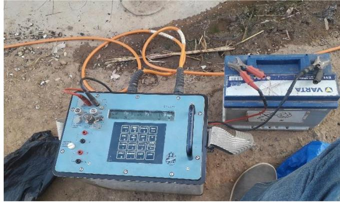
**Figure 17 : Syscal R1 plus 72 Switch**
