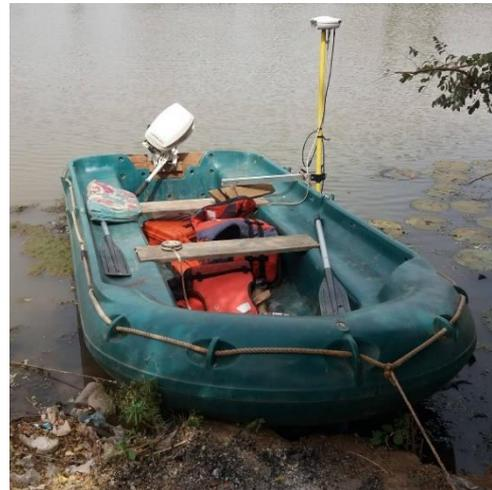
Photo 4: Sonde installée sur le bateau zodiaque
