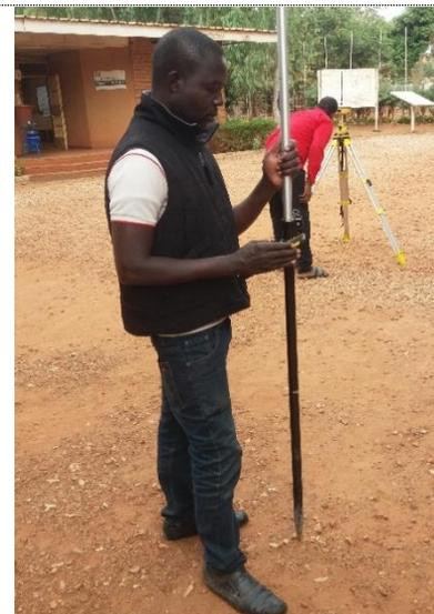
Photo 5: Récepteur E800 en mode RTK
