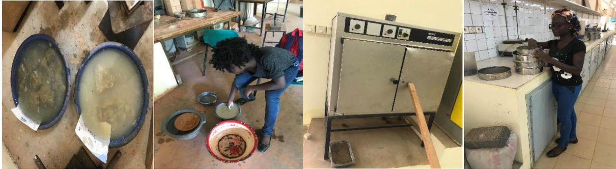
*Figure 7 : Analyse granulométrique de l'argile*
