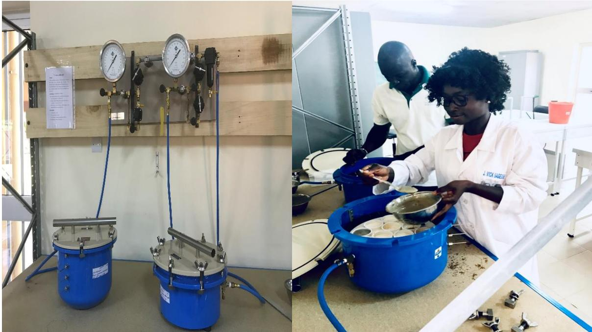
**Figure 8 : Détermination des humidités pondérales par la marmite de Richards**
