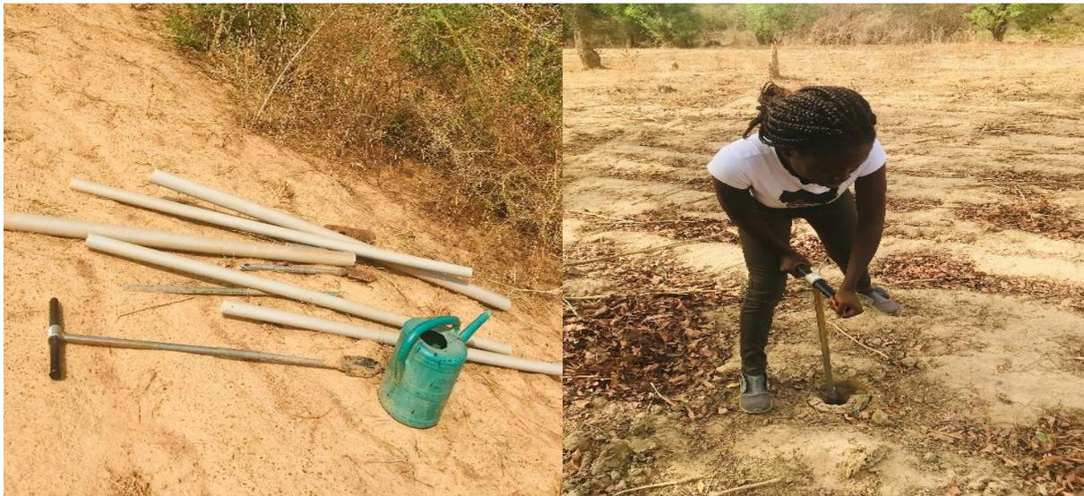
**Figure 12 : Détermination du  $K_{sat}$  par l'essai de tarière**
