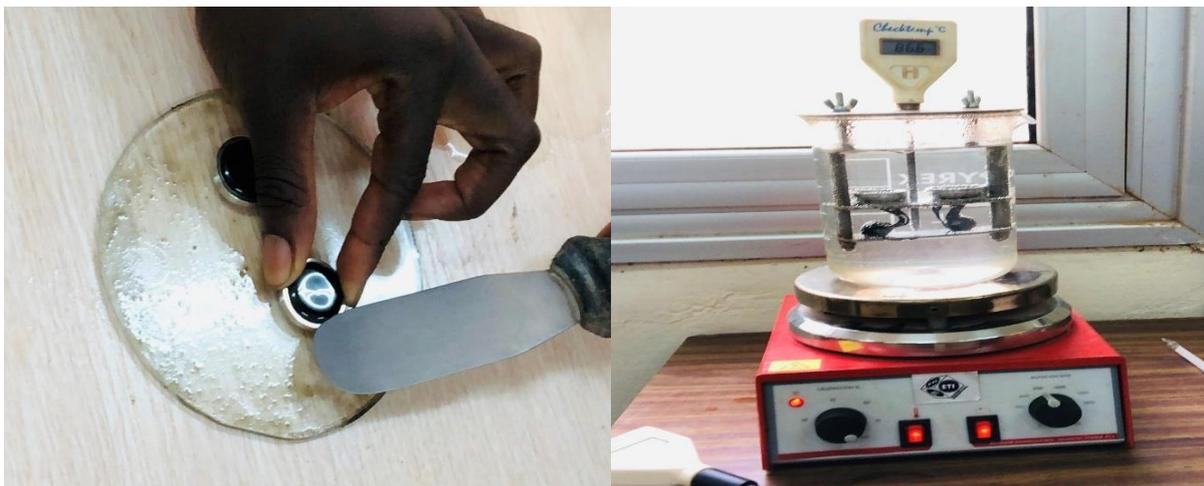
**Figure 9 : Essai du point de ramollissement bille et anneau**
