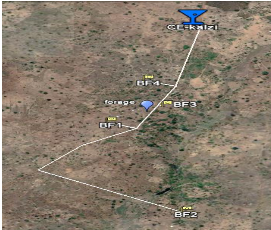
Figure 7: Tracé du réseau de KALZI
