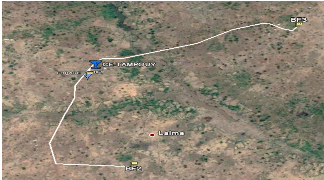
Figure 12: Tracé du réseau de TAMPOUY
