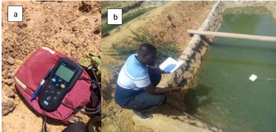
Photo 6: a : PH-Mètre, b : mesure du PH
