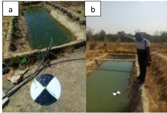
Photo 8: a : disque de Secchi, b : mesure de la transparence
