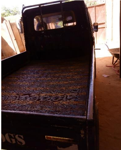
Figure 7 : Arrière de camion recouvert de matière plastique
