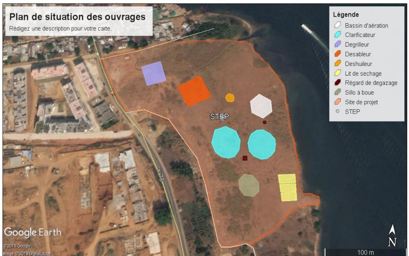
Figure 4: Plan d'implantation de la STEP
