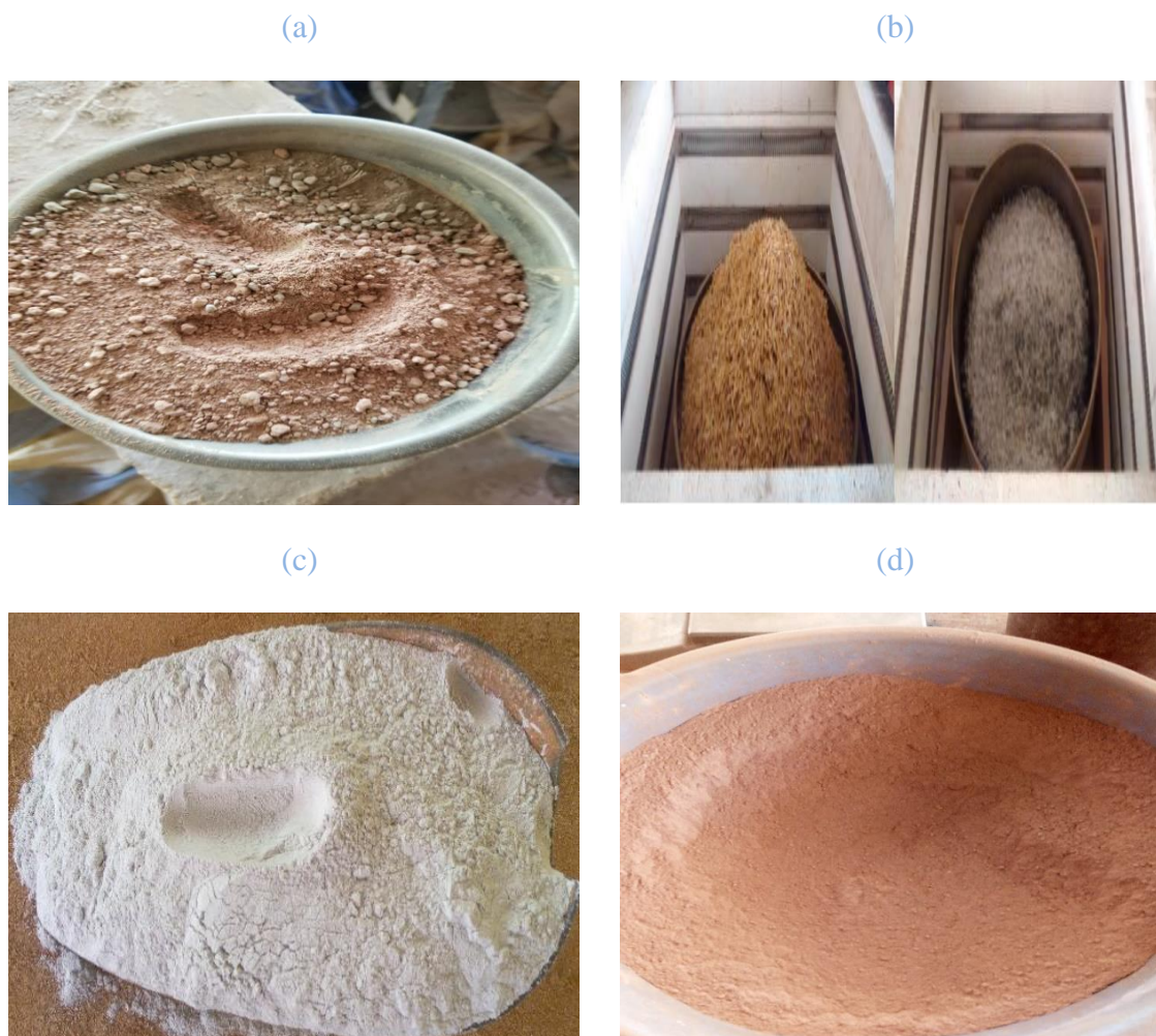
Figure 18 : (a) Argile quartée et tamisée, (b) Carbone de calcium résiduel séché, broyé et tamisé et (c) balle du riz incinéré à 500 degrés, (d) mélange d'argile plus carbone de calcium.
