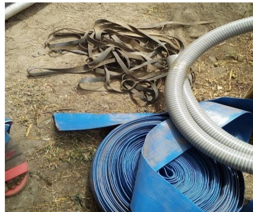
Figure 8 : Tuyaux de refoulement ou d'aspiration
