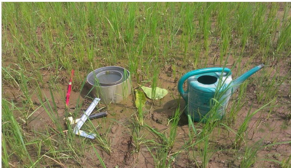
Figure 9 : Dispositif de l'essai du double anneau sur le terrain
