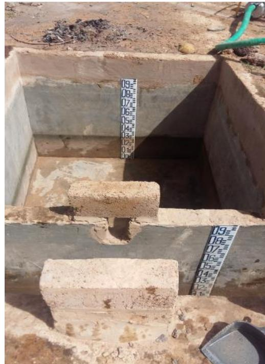
**Photo 5 et Photo 6: Dispositifs de mesure de la lame d'eau ruisselée sur les parcelles 2 et 3**
