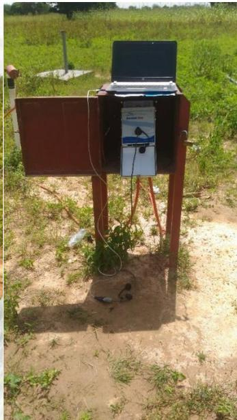
**Photo 16 : Décharge des données automatiques du lysimètre et de l'humidité du sol**
