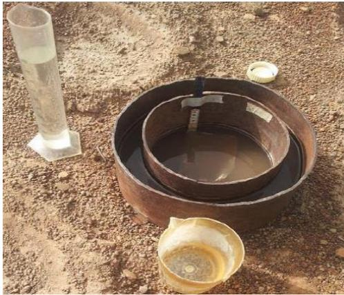
**Photo 2 : Essai d'infiltrométrie au Muntz**
