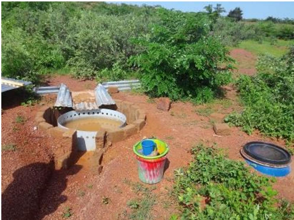
**Photo 4 : Dispositif de mesure de la lame d'eau ruisselée sur la parcelle**
