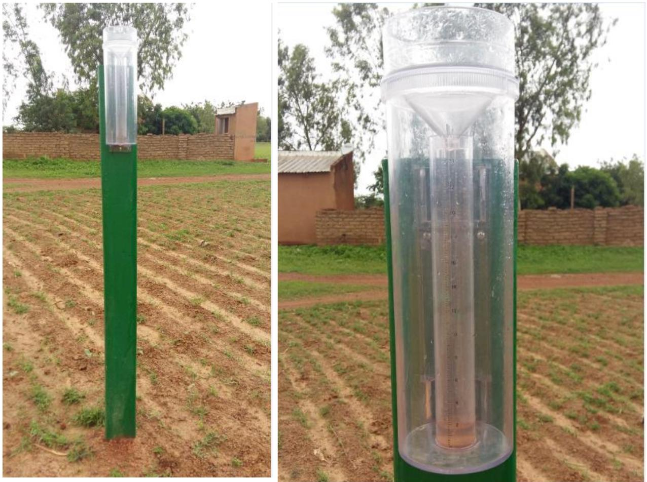
**Photo 3 : Pluviomètre à mesure directe sur support**
