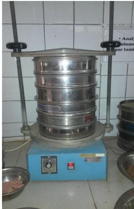
**Photo 14 : Exemple de tamisage des échantillons au laboratoire**
