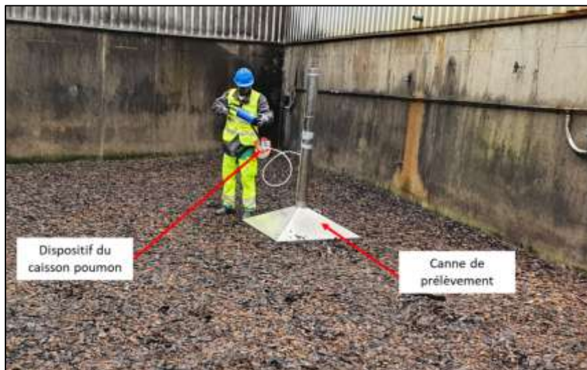
Figure 12 : Prélèvement sur source surfacique solide (biofiltre)
