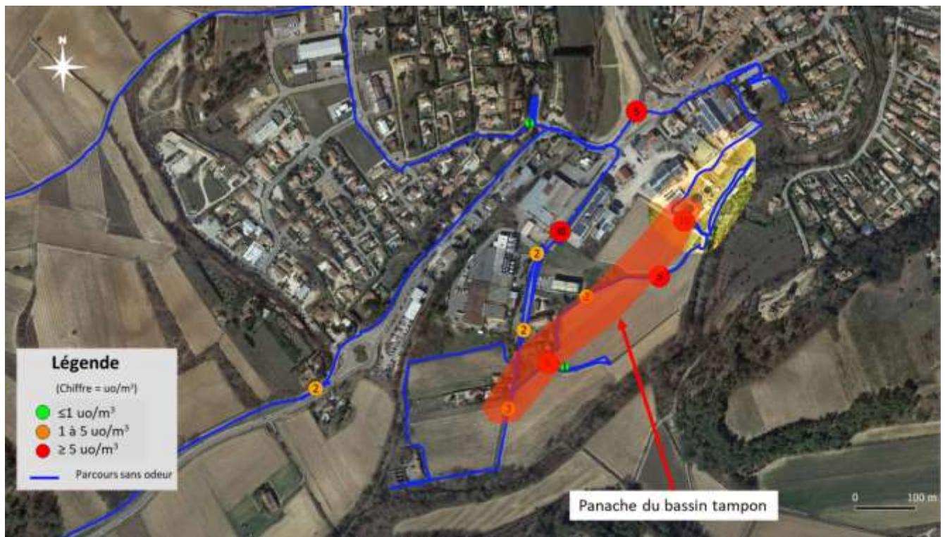
Figure 19 : Parcours de mesure des odeurs dans l'environnement de la station d'épuration
