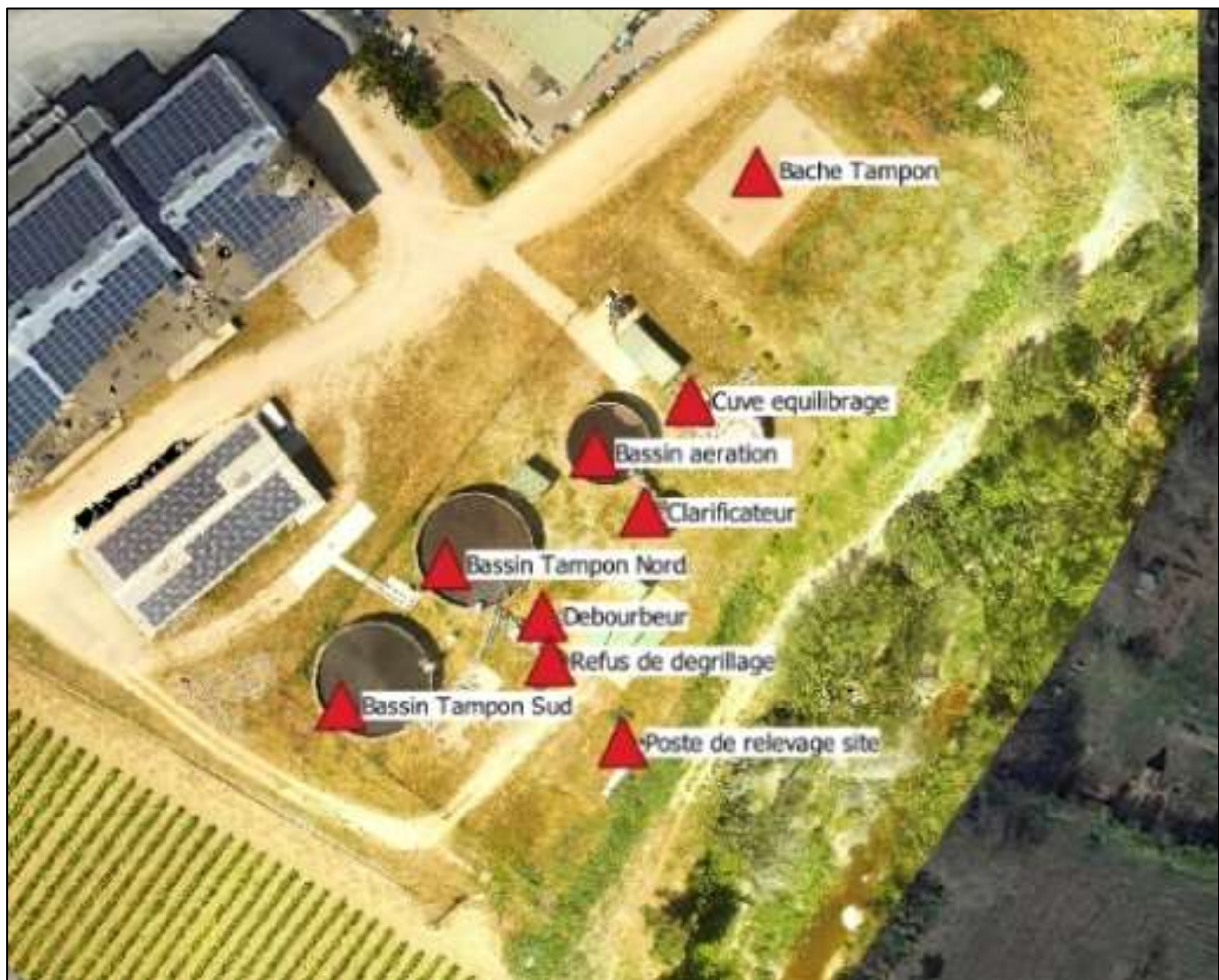
Figure 16 : Points de prélèvements au niveau des ouvrages de la station d'épuration
