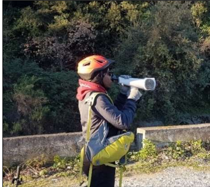
Figure 15 : Mesure de concentrations d'odeurs dans l'environnement
