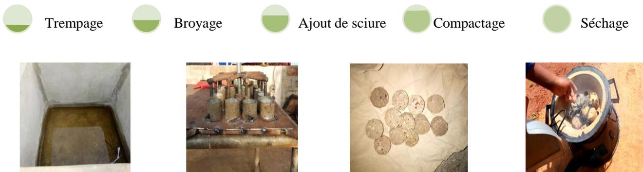
*Figure 19 : Briquettes combustibles issues de la valorisation des emballages de ciment et de la sciure de bois*
