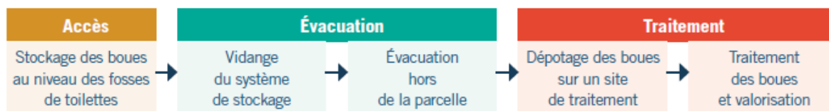
Figure 1: Filière de l'assainissement non collectif (Memento de l'assainissement, 2018).
