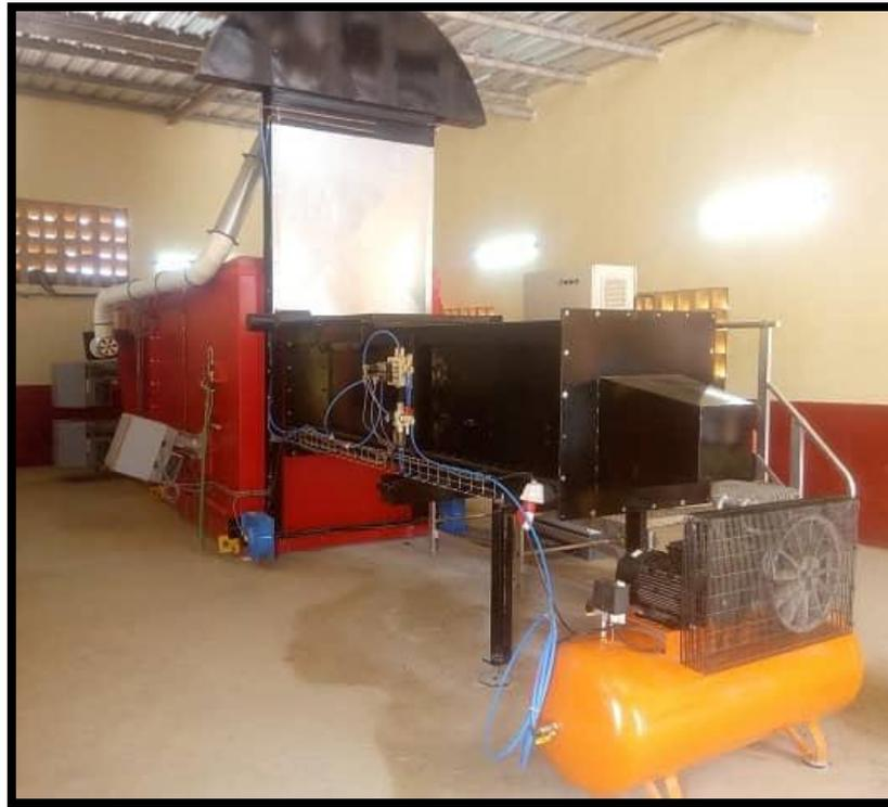
Figure 32: Incinérateur à double chambre sans traitement des gaz de combustion du CTVD de Ouagadougou
