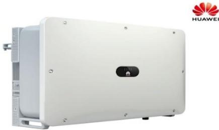
convertit le courant DC généré par les branches PV en courant AC. Il s'applique aux systèmes photovoltaïques raccordés au réseau pour les centrales PV commerciales sur les toits et les grandes centrales photovoltaïques. L'onduleur choisi délivre une puissance active maximale de 175 kW à 40°C avec un rendement maximal de
