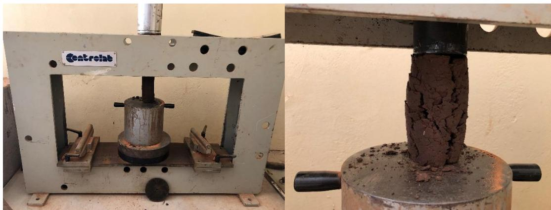
Figure 25: Test de résistance à la compression.
