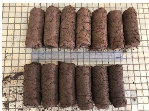
Figure 26: Aspect des briquettes D.5.50 et D.10.50.
