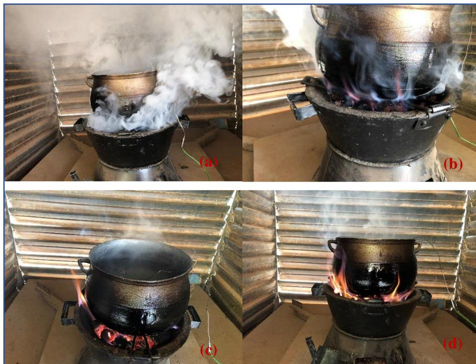
Figure 24: Evolution des fumées durant la combustion des briquettes.
