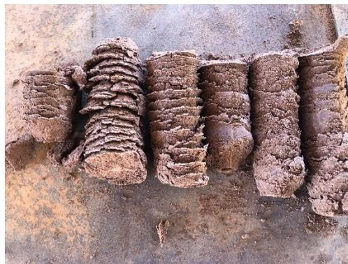
Figure 29: Aspect des briquettes D.10.60 après séchage.
