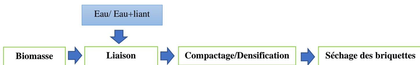
Figure 5:Processus de fabrication des briquettes.
