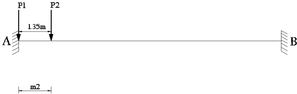
Figure 6.8 : disposition la plus défavorable des charges Bt pour le cisaillement
