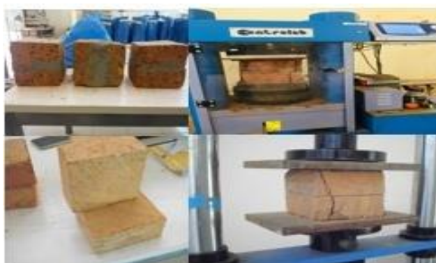
Figure 10 Dispositifs de détermination des essais en compression
