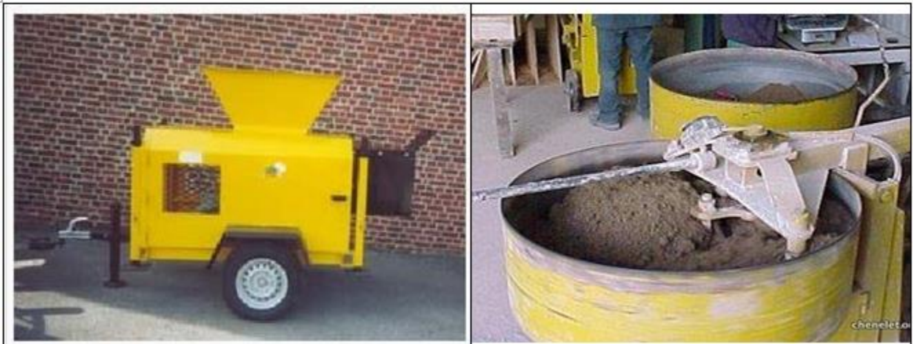
Figure 4 : Équipements de préparation de la terre de confection de BTC
