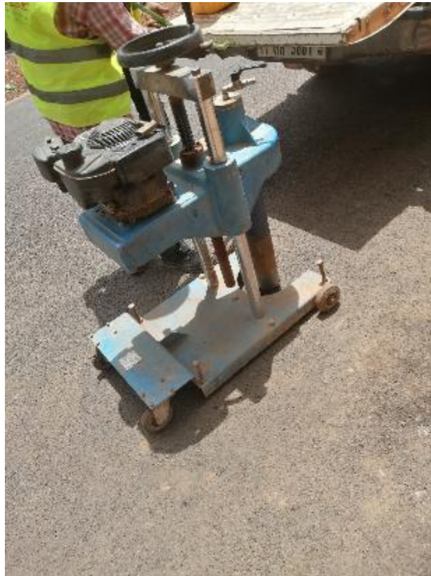
Photo 14 : Appareil utilisé pour le prélèvement des carottes pour l'essai de mesure des épaisseurs et de compacité.
