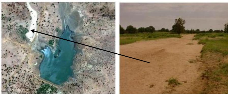
**Photo 2** : Processus d'ensablement en amont du barrage de Lagdwenda
