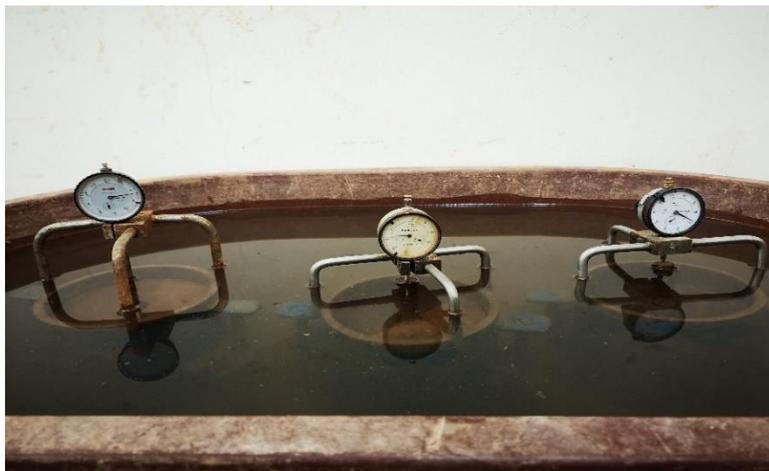
*Figure 11: éprouvettes CBR imbibées et capteurs pour mesure le gonflement*
