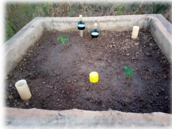
*Photo 8: Deux (2) tensiomètres installés dans le lysimètre*
