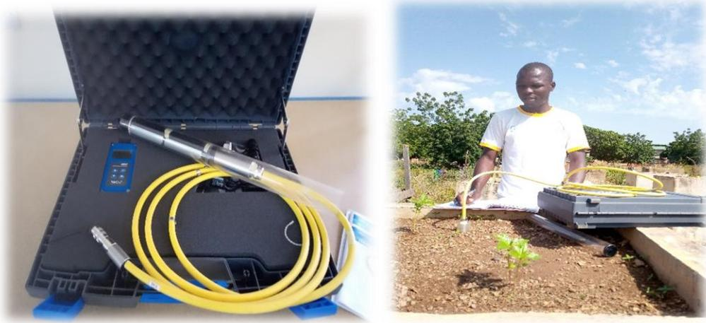
*Photo 7: Humidimètre TRIME-PICO IPH et la procédure de mesure de l'humidité*
