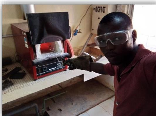
Photo 3: Etuve –US 006 de marque Heraeus (à droite) et mise des échantillons dans le four à moufle – US 005
