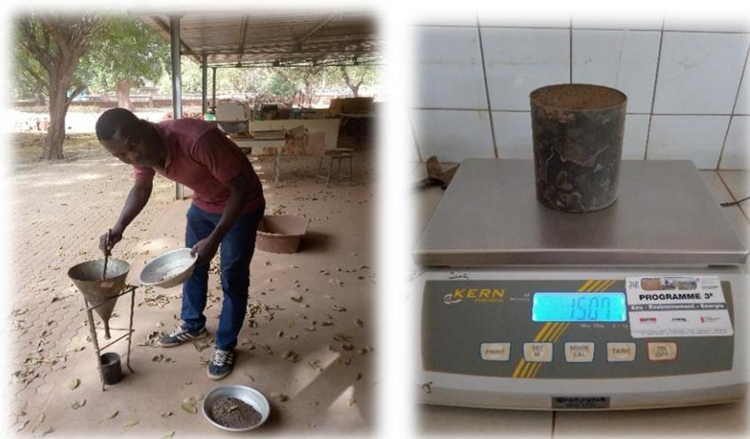
*Photo 6: Réalisation de l'essai pour la détermination de la densité apparente sèche*
