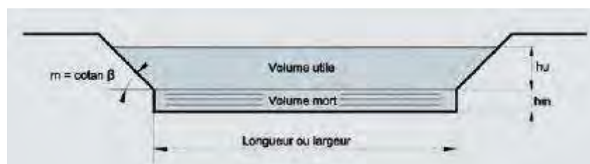
Figure 9 : coupe du bassin de traitement (source GTPOR)
