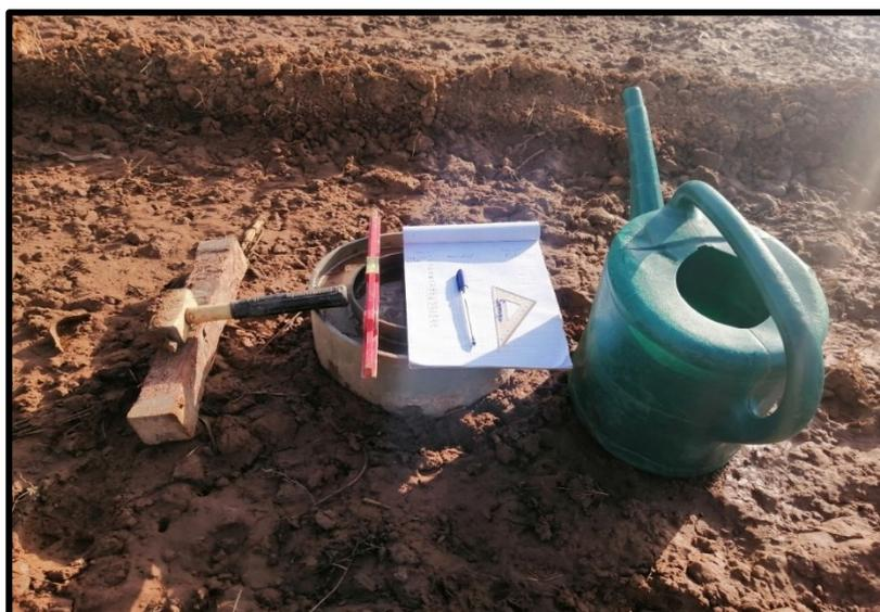
Figure 3 : Mesure d'infiltration sur le terrain (méthode du double anneau)
