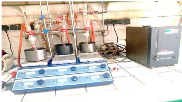
Figure 7 : Le dispositif de la réaction de transestérification
