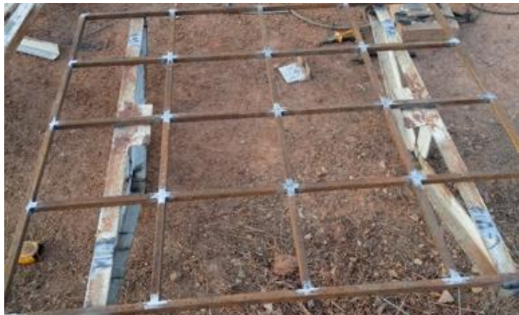
Figure 33. Illustration de la pose des cornières sur le réflecteur
