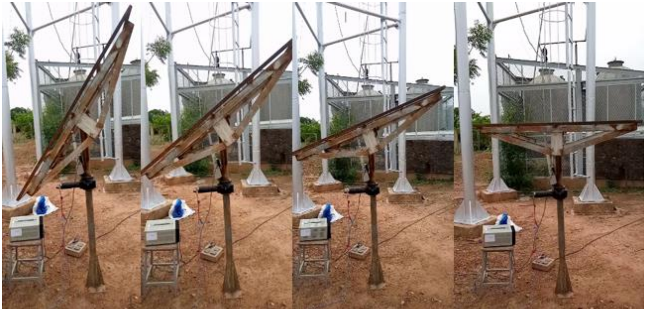
Figure 39. Illustration du fonctionnement de l'héliostat en élévation
