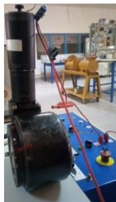
Figure 29. Couronne d'orientation alimenté sous une tension de 12 VCC (Tension continue)
