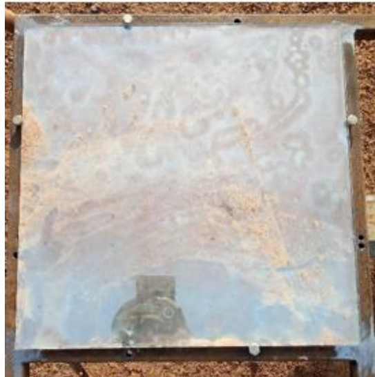
Figure 35. Test de fixation du miroir sur le réflecteur
