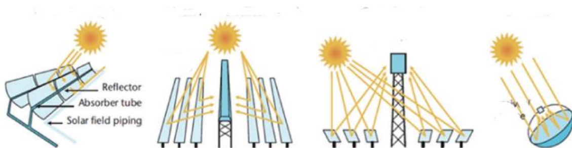
Figure 2. Illustration des technologies de centrales solaires à concentration[5]
