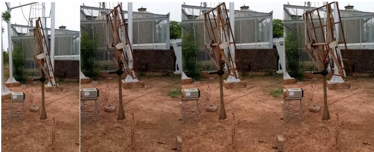
Figure 40. Illustration du fonctionnement de l'héliostat en azimut
