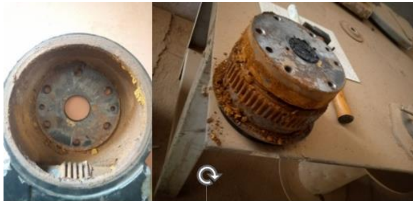
Figure 28. Intérieur de la couronne d'orientation avant nettoyage
