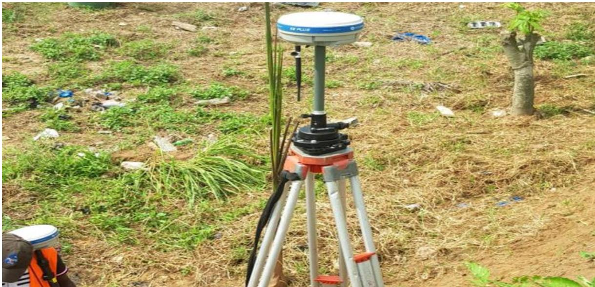
Figure 4 : GPS différentiel STONEX utilisé dans le cadre du projet de Dioro (Décembre 2021).
