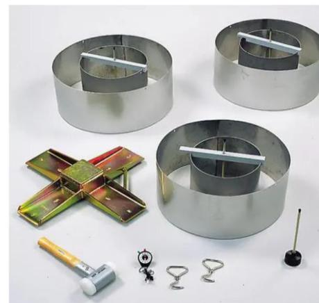
Figure 18 : Dispositif de la méthode de double anneau
