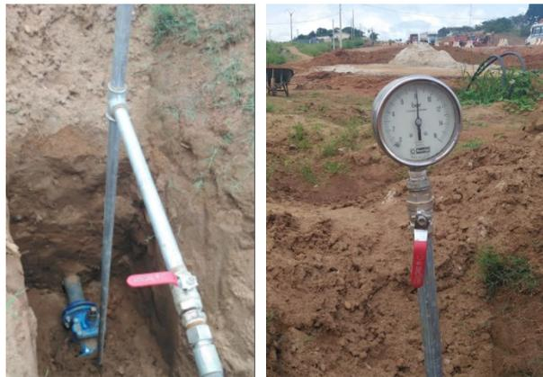
Figure 13: Manomètre et la canne d'essai de pression
