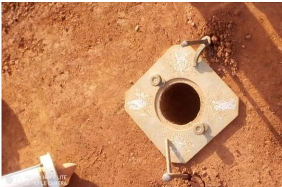
Figure 15: essai de densitomètre à membrane
