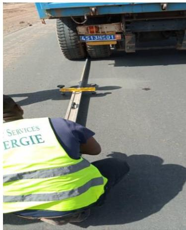
*Figure 19: Essai de déflexion (couche de base)*
