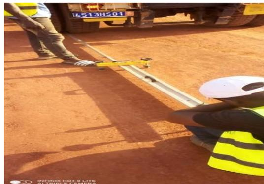
Figure 14: Essai de déflexion
