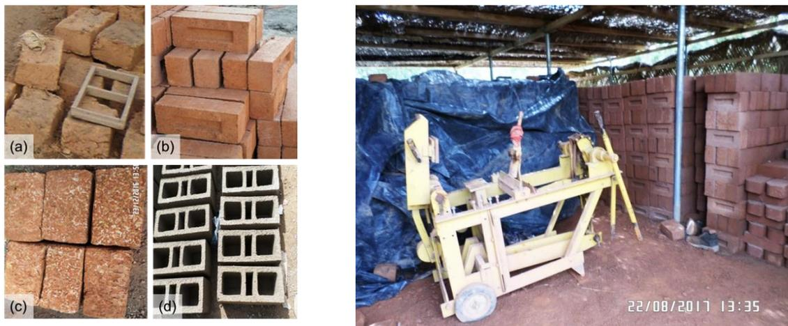
**Photo 1 :** Les types de matériaux de construction (a,b, c,d) et une presse manuelle de production de la BTC
