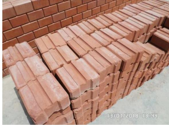
**Photo 17:** Les blocs de BTC petites dimensions et les blocs autobloquants
