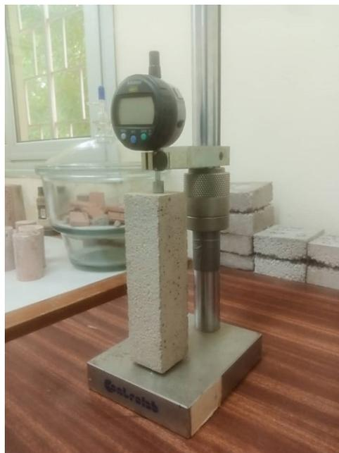
Figure 24: Rétractomètre numérique pour les mesures de retrait total
