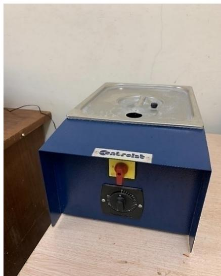
Figure 23: Appareil de Chatelier pour mesure de la stabilité
