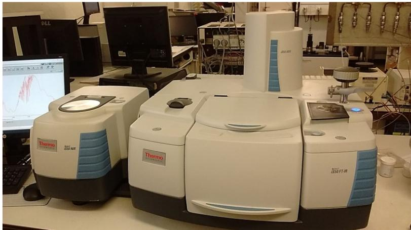
Figure 21: Spectromètre de type Nicolet™ iS50 IRTF
