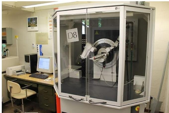
Figure 20: Diffractomètre D8 Advance
