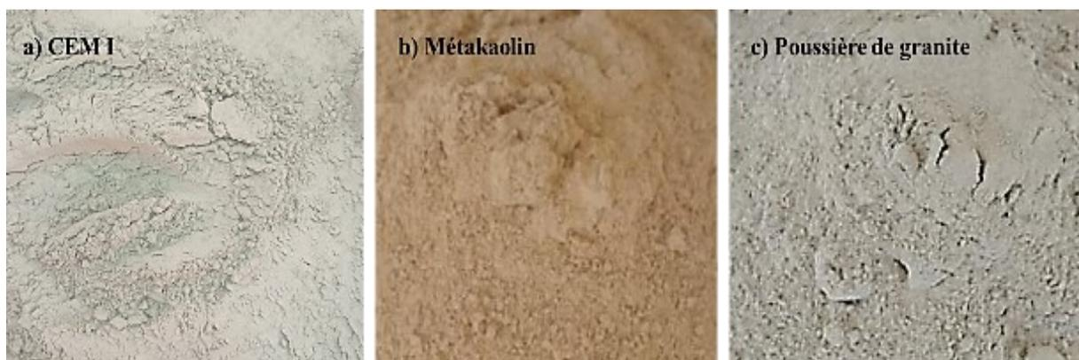
*Figure 45: Images du CEM I (a) et des additions minérales : b) Métakaolin et c) Poussière de granite*
