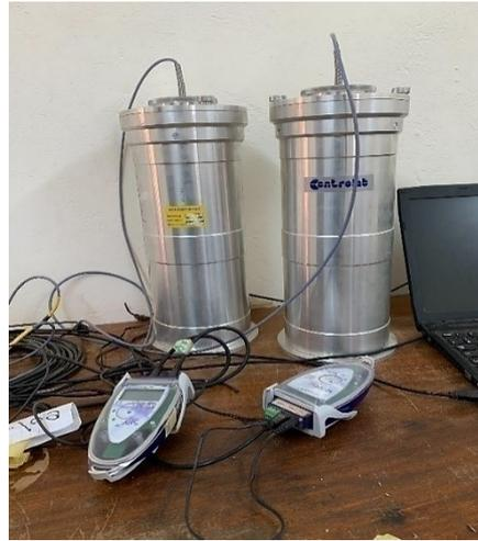
Figure 25: Calorimètre semi-adiabatique couplé au logiciel CemTech pour mesure de la chaleur d'hydratation
