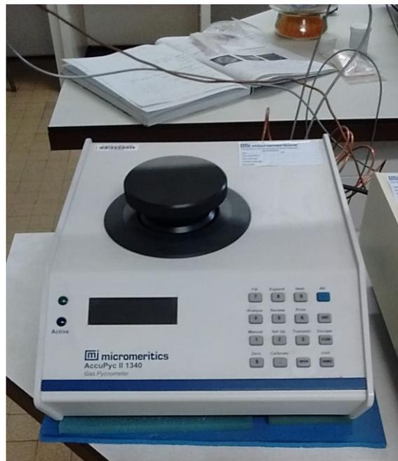
Figure 17: Pycnomètre à hélium AccuPyc II 1340 de Micromeritics
