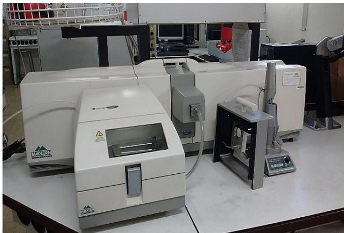
Figure 15: Appareil de mesure de la granulométrie au laser, type Malvern Mastersizer 2000
