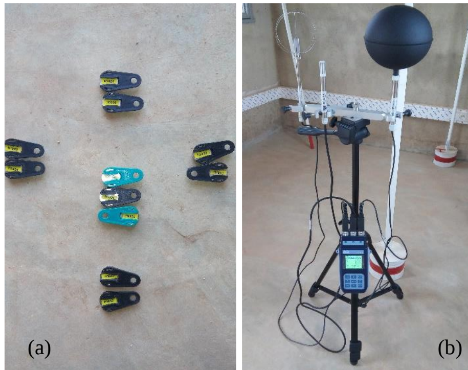
Figure III-7 : (a) Micropuces (Thermopuces et Thermohygropuces), (b) Appareil d'acquisition de paramètres climatiques.
