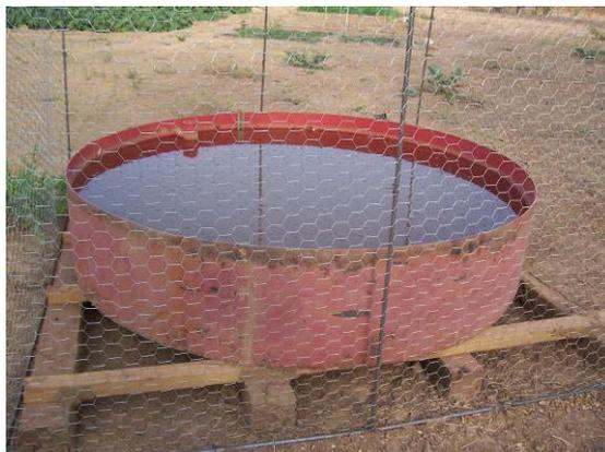
**Figure 12: bac d'évaporation du site expérimental du 2iE (classe A)**
