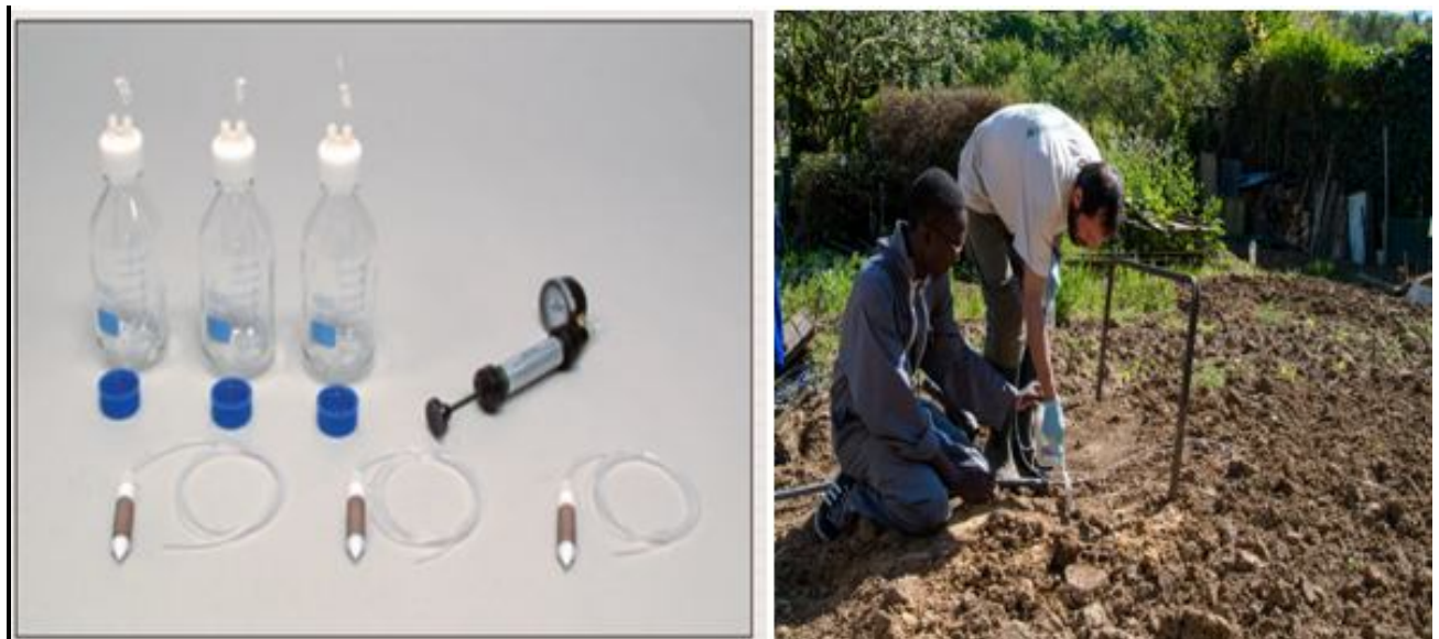
Figure 12: préleveurs PTFE/quartz et la photo de leur mise en place
