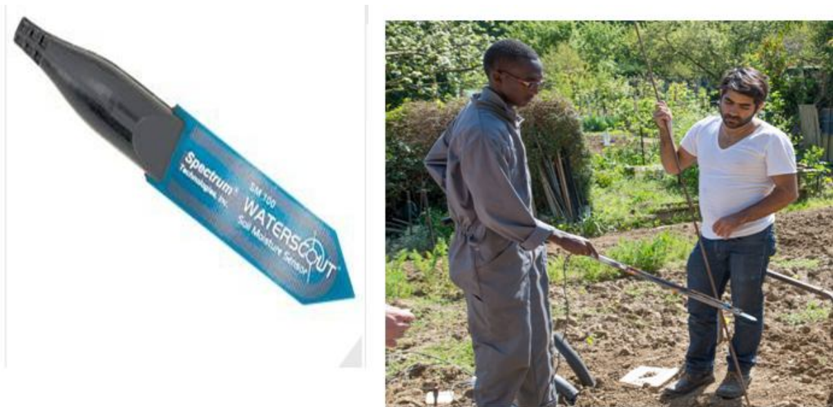
Figure 11: Sonde WaterScout et la photo de sa mise en place
