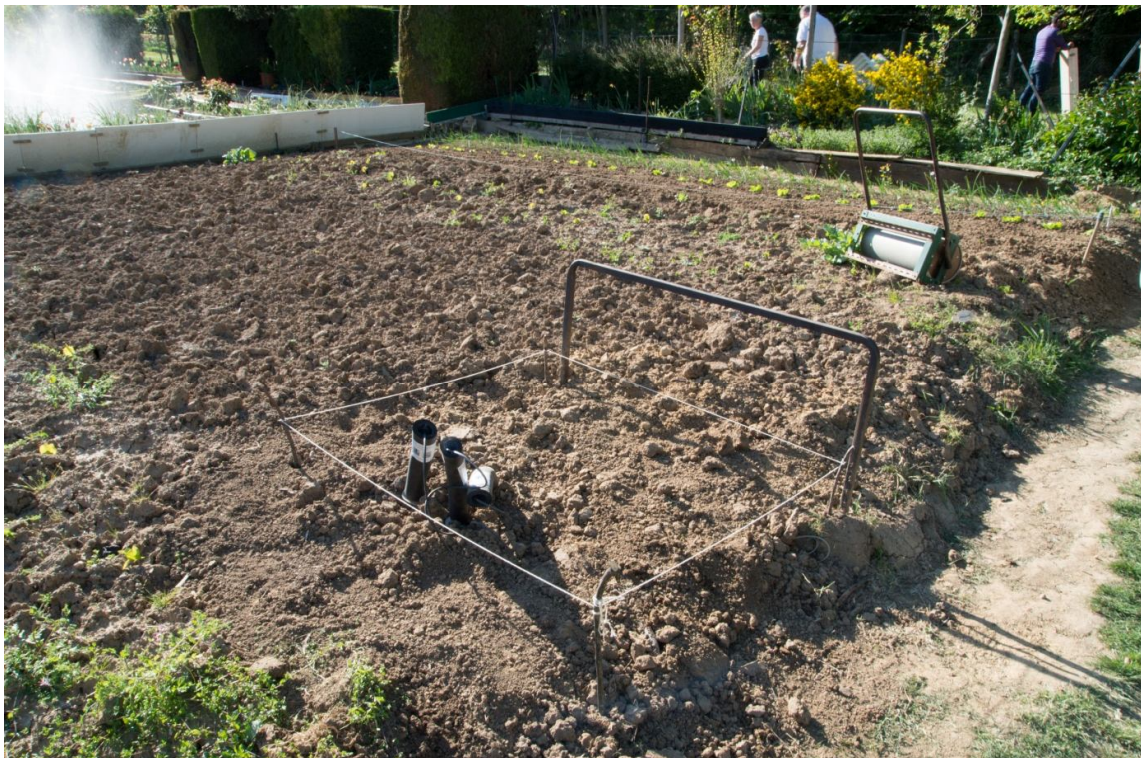
Figure 9 : Photo du site tensiomètre, bougies poreuses et humidimètre
