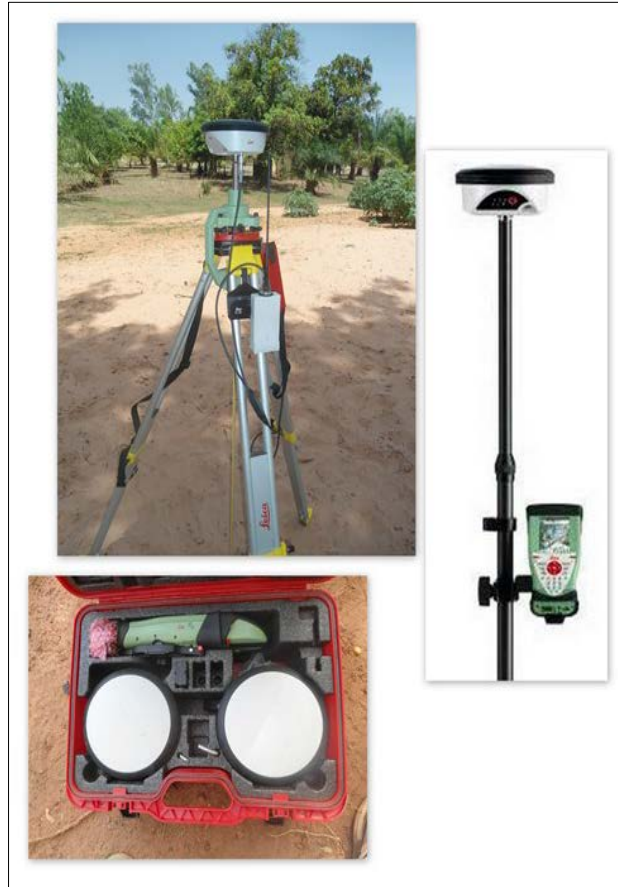
Figure 7 : Aperçu du DGPS
