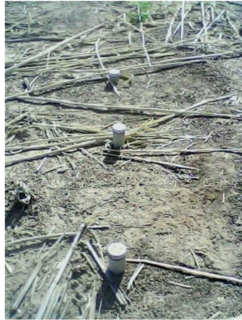
Photo 5: Tubes neutroniques dans une parcelle
