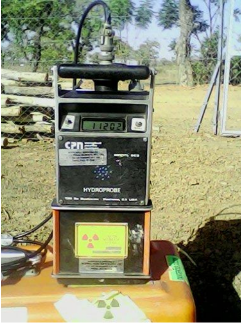
Photo 4 : La sonde à neutrons utilisée
