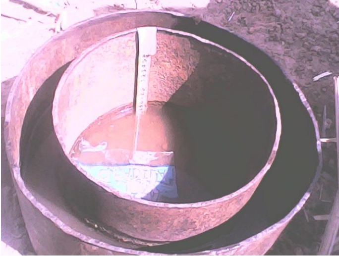
Photo 6 : L'infiltromètre de Müntz
