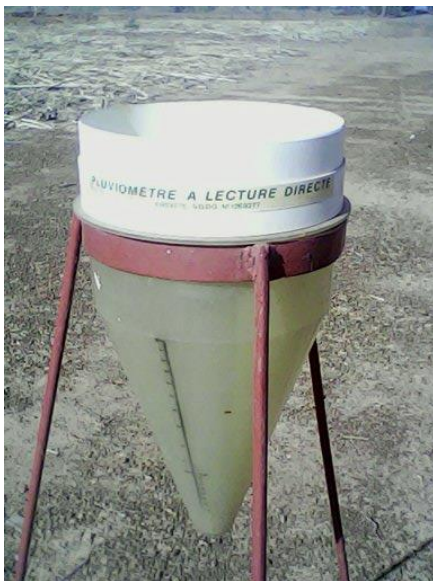
Photo 3 : Le pluviomètre à lecture directe installé sur le site expérimental
