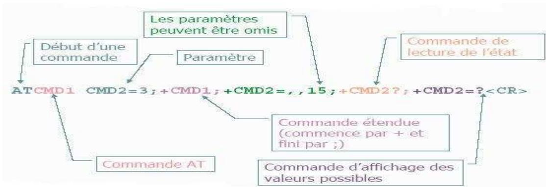
Figure A.3 : syntaxe de commande d'une commande AT étendue [15]
