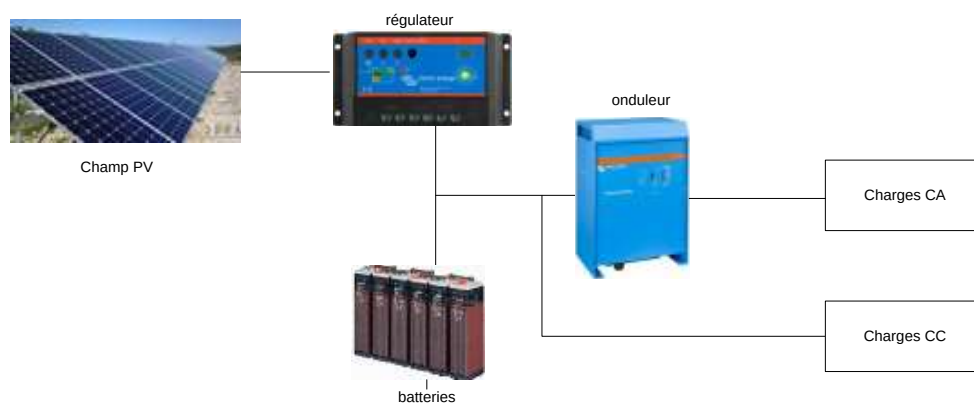
Figure 7 : schéma descriptif des systèmes PV autonomes [8]
