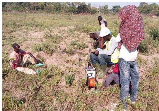
Figure 7: Mise en place du dispositif pour le trainé électrique
