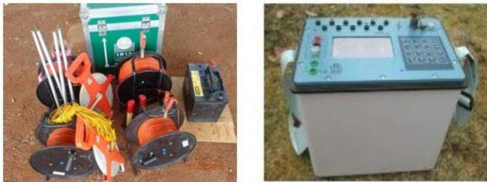
Figure 4: Résistivimètre Syscal et ses accessoires
