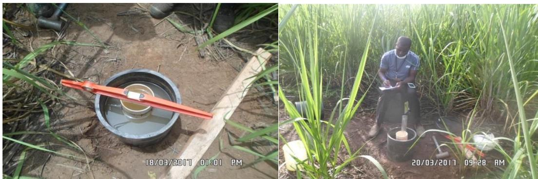
Figure 9: Mesure d'infiltration.
