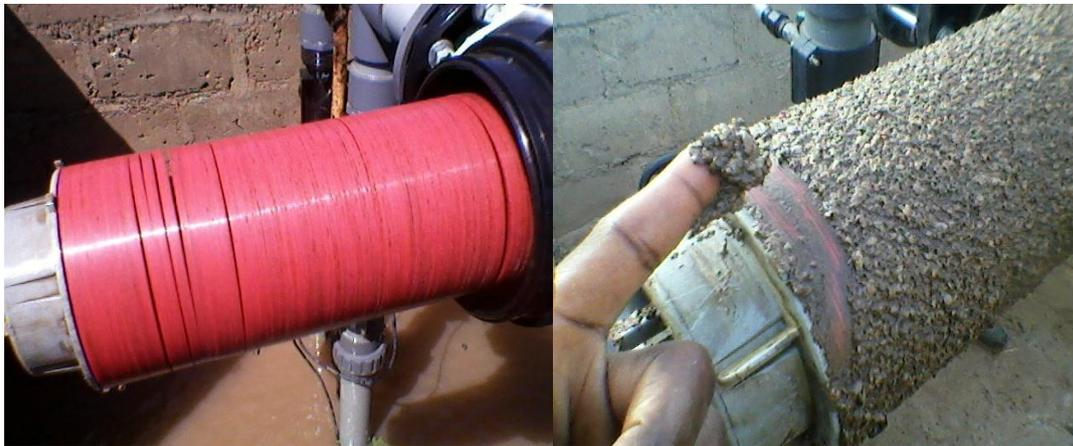
*Figure 7: Filtre propre et colmaté*
