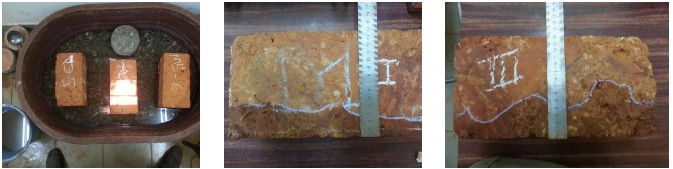
Image 12 : Dispositif d'immersion et aperçu sur la remontée capillaire des échantillons de Diébougou
