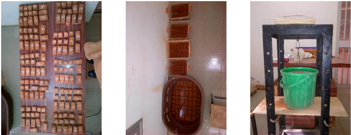
Image 9 :Aperçu sur le dispositif de détermination de la porosité accessible à l'eau
