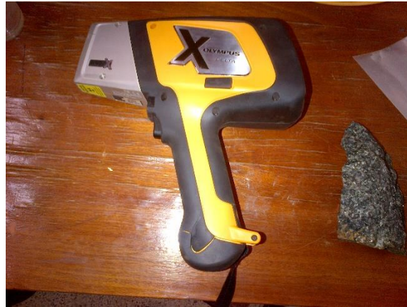
Image 8 : Appareil XOlympus Delta pour DRX
