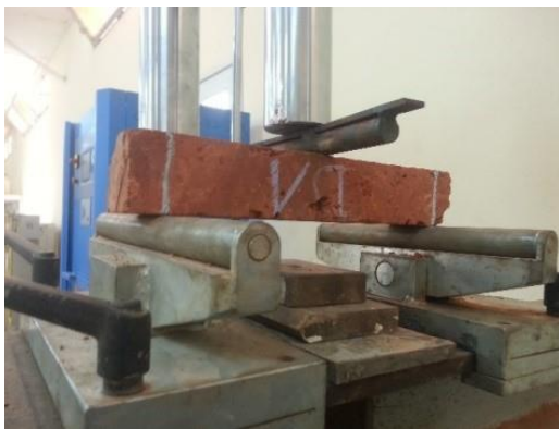
Image 14: Aperçu sur le dispositif de résistance à la flexion sous charge centrée
