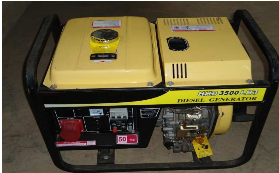
Figure III.3: Photo montrant le générateur diesel, modèle HHD3500LH3, marque JINAODA avec une puissance maximale de 3 kW
