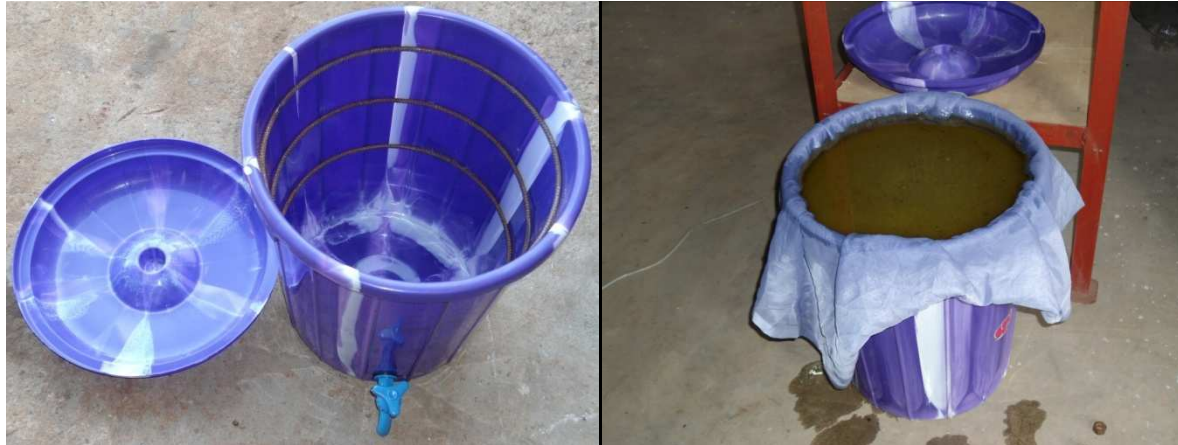
Figure III.2: Photo montrant le seau en plastique avec les 3 niveaux de filtration (à gauche) et le seau avec les cerceaux entourés du tissu filtrant (à droite) lors de la filtration
